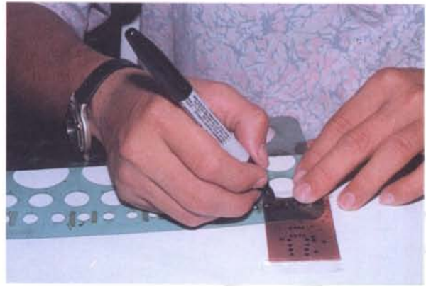
Figura 5.26. Haciendo las líneas para unir los puntos
